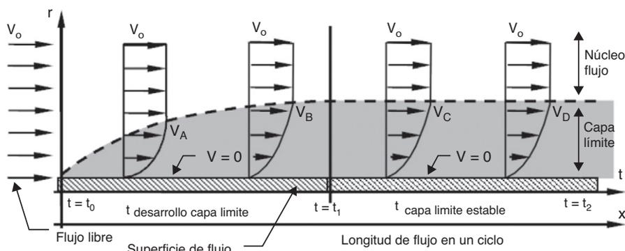
**Figura 6** Estructura de flujo continuo. Al iniciar el flujo empieza a formarse la capa límite que continua desarrollándose hasta que se equilibran las fuerzas inerciales y viscosas, después de lo cual permanece estable. La velocidad siempre es 0 ( $V=0$ ) sobre la pared.  $V_o$ : velocidad de entrada;  $V_i$ : velocidad del flujo en el punto  $i$ ;  $r$ : radio del conducto;  $t$ : tiempo transcurrido del ciclo.
