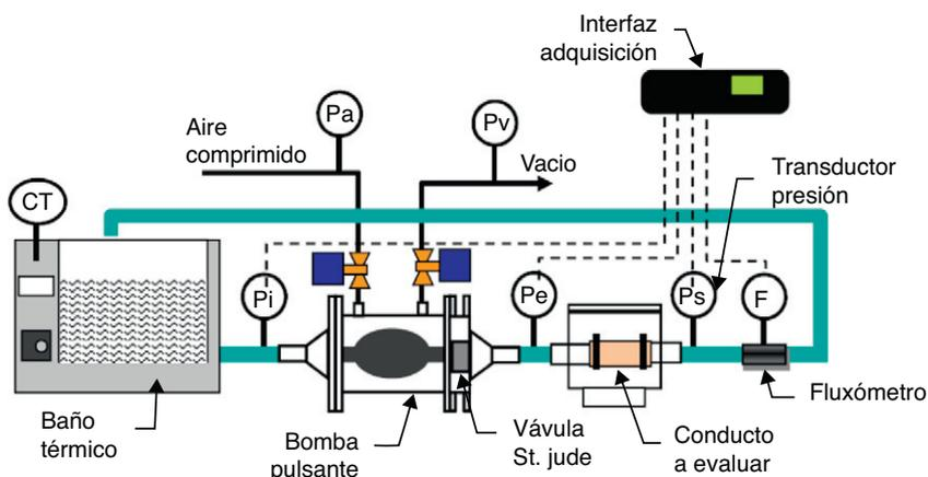
**Figura 1** Banco de pruebas para flujo pulsante. Consta de bomba de flujo pulsante (cámara rígida, saco elástico y válvula bivalva St. Jude® en la salida), baño térmico con control de temperatura, fluxómetro y transductores de presión (en la entrada de la bomba y en la entrada y salida del conducto). Modificada de Bustamante J et al.<sup>14</sup>.
