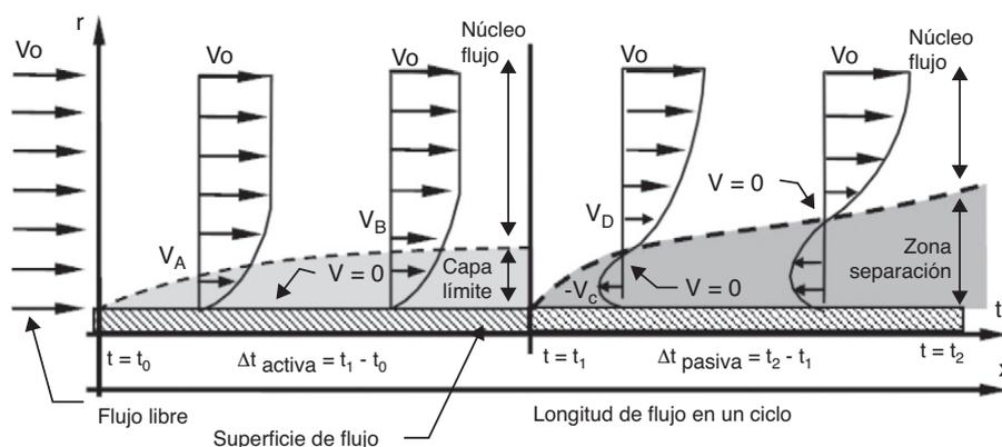
**Figura 4** Estructura de flujo pulsante cerca de la pared de un conducto elástico. Durante la fase activa se forma capa límite y la velocidad es 0 ( $V=0$ ) sobre la pared; en cambio, durante la fase pasiva es 0 en un punto entre el centro y la pared.  $V_0$ : velocidad de entrada;  $V_i$ : velocidad del flujo en el punto  $i$ ;  $r$ : radio del conducto;  $t$ : tiempo transcurrido del ciclo.
