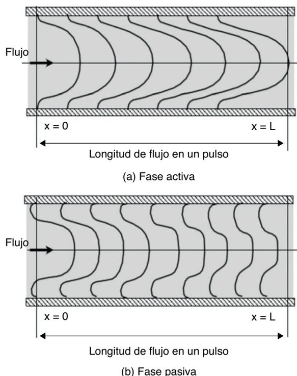
**Figura 5** Estructura del flujo pulsante. **A)** Fase activa: la corriente avanza con velocidad de perfil parabólico, conformando el flujo anterógrado. **B)** Fase pasiva: hay 2 corrientes, una que se mantiene en el núcleo con un perfil achatado, y otra con velocidad negativa en dirección radial, la cual conforma el flujo retrógrado. Modificada de Fung Y<sup>19</sup>.
